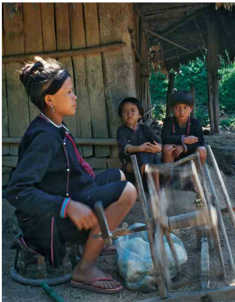
Un outil du passé pour bobiner les fils de coton destinés au tissage.
